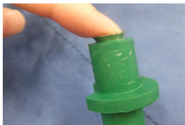
＜金属部分の飛びだし＞
