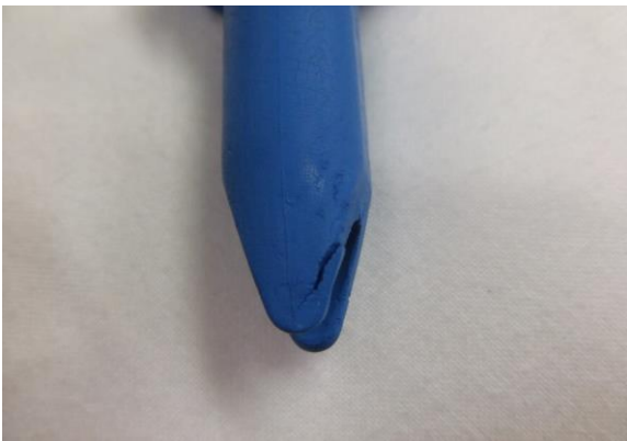
＜劣化による破損＞
