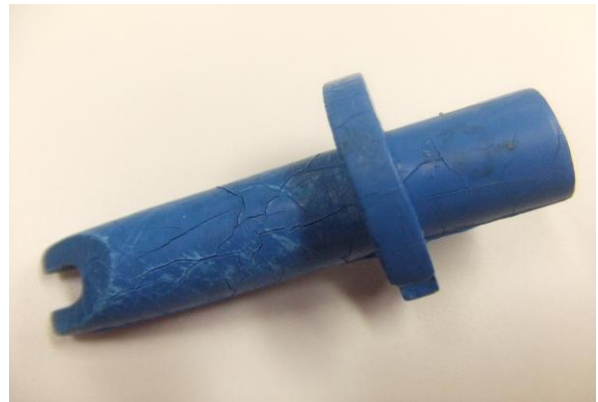
＜劣化によるひび割れ＞
