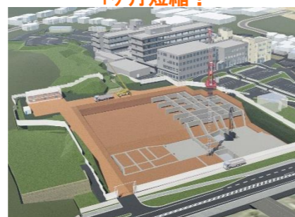
STEP3: 令和4年1月上旬頃 N工区: 基礎躯体中 S工区: 基礎躯体完了～埋戻し中
